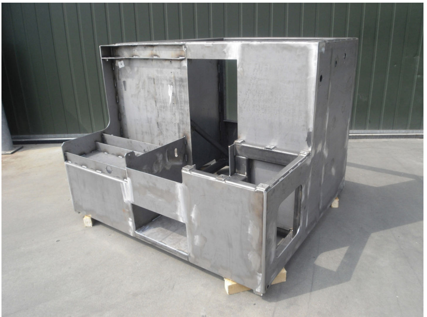
Figuur 2d: Gelast stalen frame voor oppervlaktebehandeling
